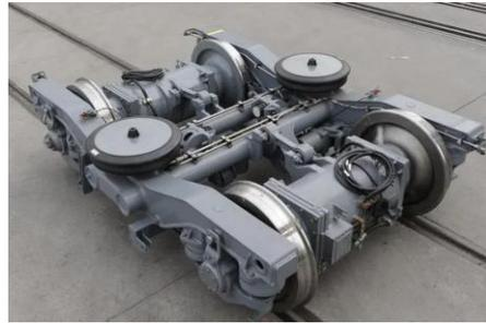
中国中车从德国西门子引进了时速 350 公里的高速动车组技术。由于外方此前也没有如此高速的运营先例，转向架制造成了双方共同攻关的课题。李万君参加了转向架焊接工艺评定专家组，并发挥了高技能人才的特殊作用。以李万君试制取得的有关数据为重要参考，企业编制的《超高速转向架焊接规范》在指导批量生产中解决了大问题。
