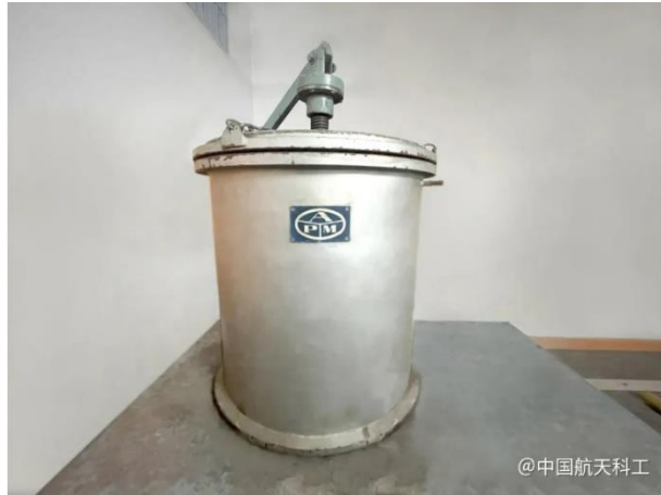
图 1 中国航天科工三院 35 所厂房的第一代钎焊炉
