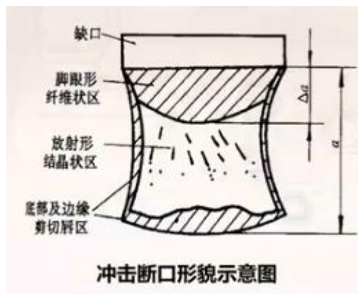
图 5 断口形貌法表征韧脆转化温度
